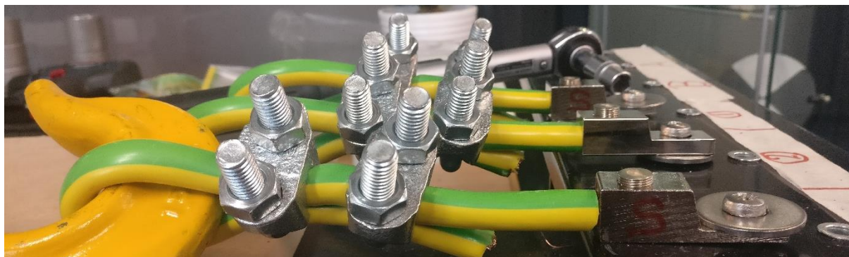
Afbeelding 4: Messing Aardklem aangesloten op de testopstelling
